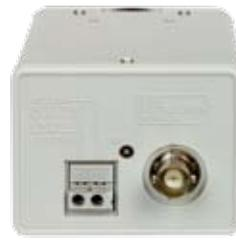
Цветные камеры ZC-Y12 имеют сенсоры, построенные по технологии HQ1 с разрешением 540 ТВ линий и позволяют использовать объективы с автодиафрагмой DC или Video или с ручной диафрагмой. Камеры имеют прочный и компактный корпус. Крепление на кронштейн может осуществляться как снизу, так и сверху при помощи 1/4" винта. Конфигурирование ZC-Y12 осуществляется при помощи DIP переключателей.
