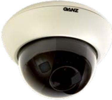
Серия ZC-D5000 идеально подходит для видеонаблюдения в сложных условиях освещённости благодаря чувствительности 0,83 люкс. Для этой серии предусмотрен ряд различных CS объективов. В их числе как объектив с фокусным расстоянием 5 – 50 мм, так и широкоугольный 2,9 – 8,2 мм. Камеры имеют чувствительный 1/3" IT ПЗС сенсор с разрешением не менее 540 линий. Объективы для камер день/ночь серии ZC-DN имеют ИК коррекцию.
