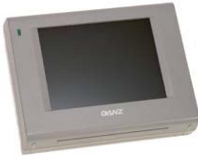
Лёгкий переносной монитор упрощает настройку камер при их монтаже. Благодаря отсеку для батарей, он независим от розетки 230 вольт, хотя может с ней работать через идущий с ним в комплекте блок питания. Ремень для переноски и козырёк экрана оставят руки свободными для настройки камеры и объектива. Отсек для батарей предназначен для шести батарей AA.
